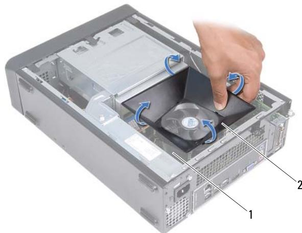
1 ventilator procesora i sklop hladila procesora
