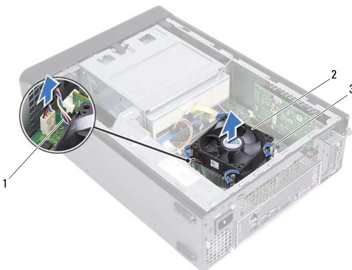
1 kabel ventilatora procesora    2 ventilator procesora i sklop hladila procesora
